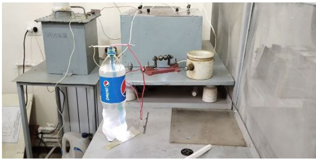
1-расм. а) Сувга электрогидравлик эффект билан ишлов бериш қурилмасининг принципиал электр схемаси б) сувга ишлов бериш жараёни.
