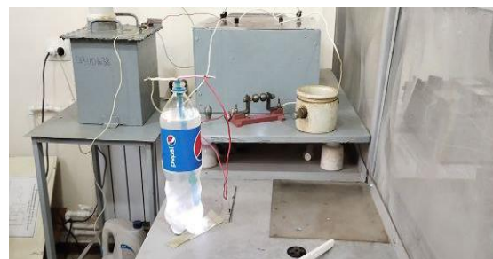
Рис. 1. а) принципиальная электрическая схема электрогидравлической установки, б) процесс обеззараживания воды.
