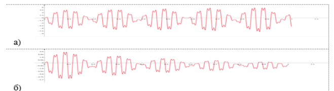
Рис. 1.4. Ток статора по оси \alpha при самораскачивании: а) в синхронном генераторе традиционным возбуждением б) в синхронном генераторе с двухосным возбуждением
