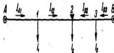
28-Rasm. Ikki manbaga ulangan liniyada toklarni taqsimlanish sxemasi
