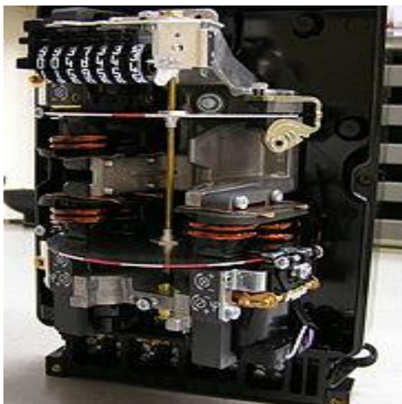
1.1-rasm. Induksion elektr hisoblagichning ochiq xolda ko'rinishi
