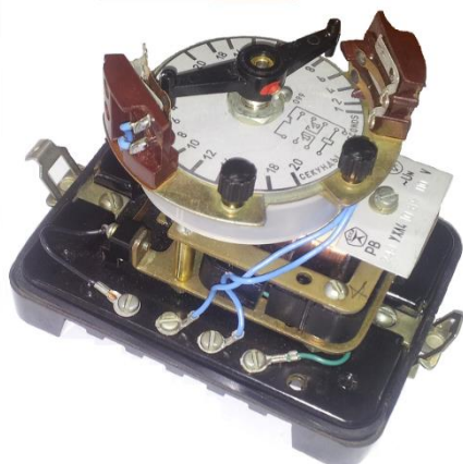
5.1-rasm. Elektromagnit vaqt relesi. a) umumiy koʻrinishi, b) tuzilishi:
