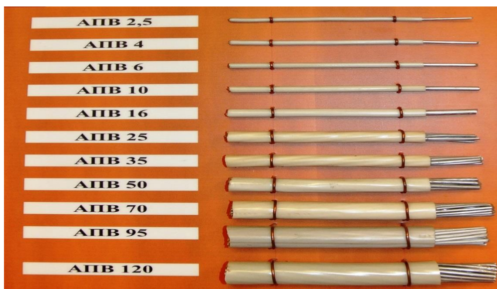
4.2-rasm. APV markali kabellarning mavjud boʻlgan kesim yuzasi.
