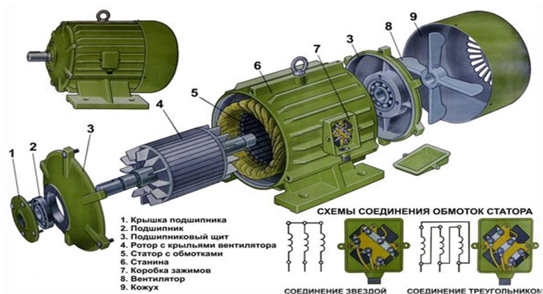
1.1-rasm. Asinxron elektr motorning tuzilishi.
