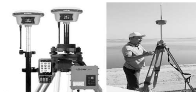
2-расм. Маълумотни қабул қилувчи АУПНТ ускунасини сунъий йўлдошга улаш ҳолати.
