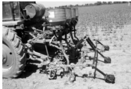
5-расм. «Эргаш Рўзимов» фермер хўжалигининг 1-тажриба участкасида автоматикасиз эгатларнинг тубини зичлаш қурилмасининг ишлаши.
