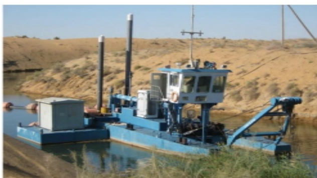
2 rasm. YX750 rusumli Xitoyda ishlab chiqarilgan elektr yuritmal zemsnaryadning ochiq kollektor kanallarini ta'mirlash tozalash jarayonlari.
