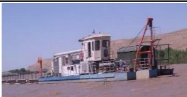
1 rasm. 10E40M32 rusumli GRU-1600/25 grunt nasosi bilan jihozlangan elektr yuritmal zemsnaryadning sug'orish kanallarini tozalash jarayonlari.
