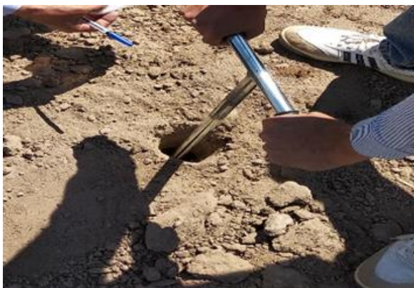
Тажриба майдончаси тупроғининг шўрланиш даражасини рақамли намликни ўлчаш асбоби ёрдамида аниқлаш жараёни
