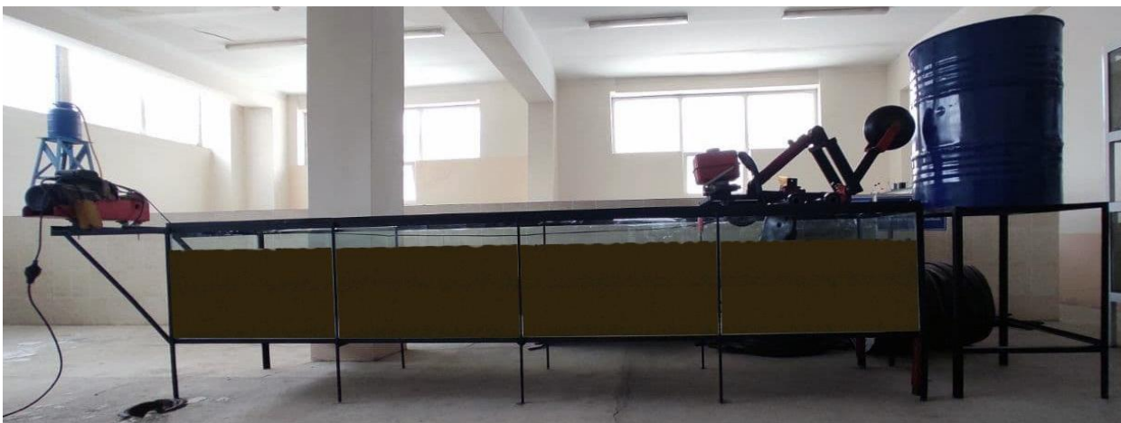
4.2.2- расм. Суғориш эгатлари гидравликсининг тадқиқоти учун ойналанган лаборатория стенд-лотогининг асл нусхаси.
