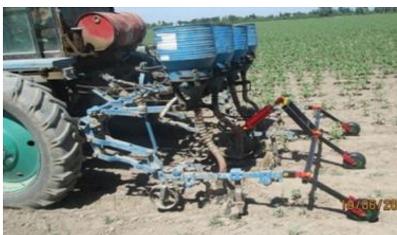
“Эргаш Рўзимов” фермер хўжалигининг тажриба даласида автоматикасиз эгатларнинг тубини зичлаш қурилмасини қўллаш жараёни.
