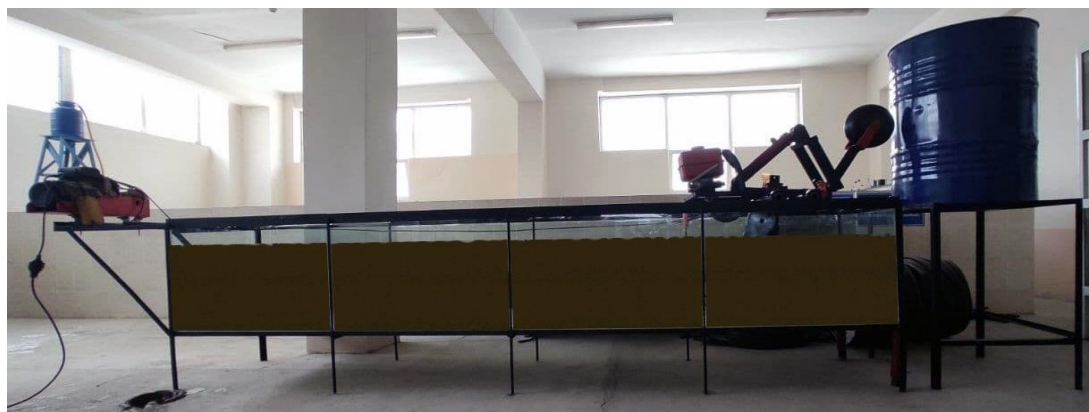
4.2.2- rasm. Sug'orish egatlari gidravlikasining tadqiqoti uchun oynalangan laboratoriya stand-lotogining asl nusxasi.
