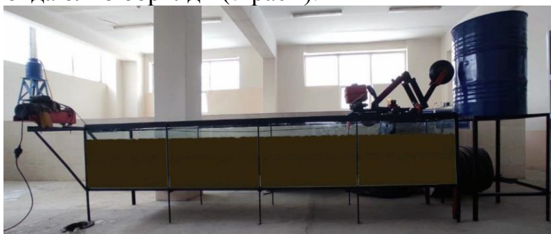
7-расм. Суғориш эгатлари гидравликасининг тадқиқоти учун ойналанган лаборатория стенд-лотоги асл нусхаси
