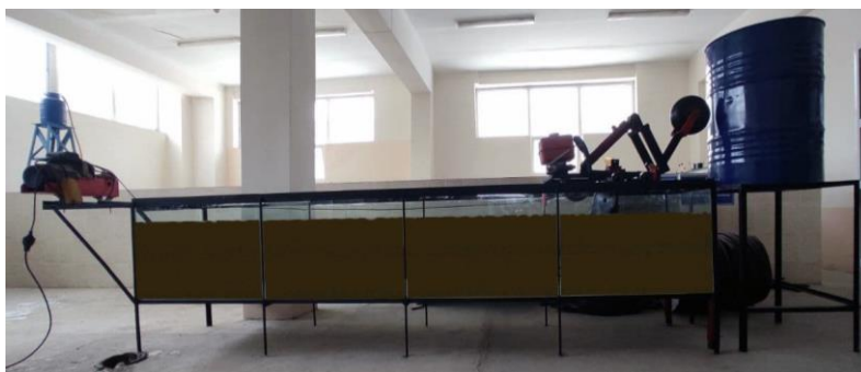
Рис.7. Оригинальный экземпляр отстекленного лабораторного стенда-лотка для исследования гидравлики поливной борозды
