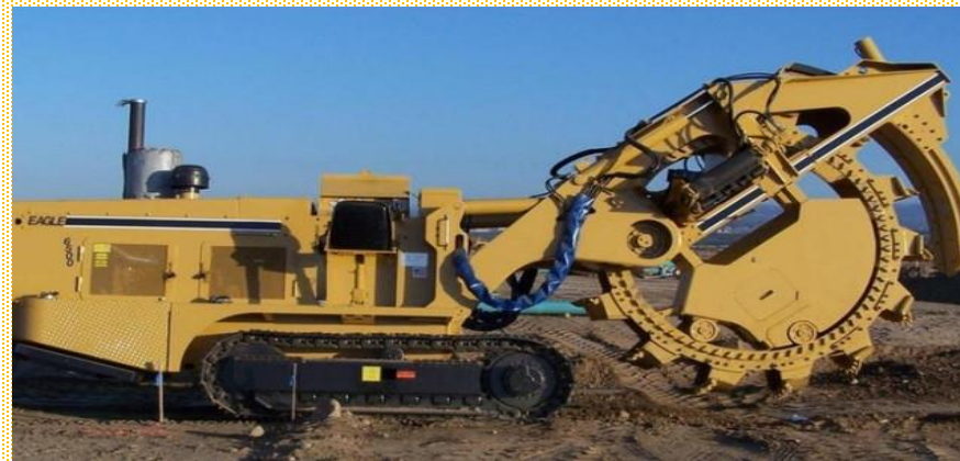
Многоковшовый экскаватор с роторным рабочим оборудованием
