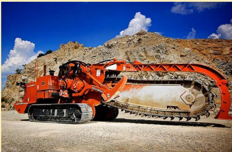
Многоковшовый экскаватор с роторным рабочим оборудованием
