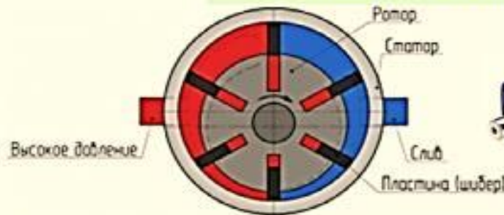
Конструкция пластинчатого гидромотора однократного действия
