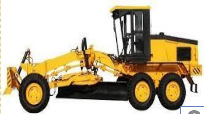
**Механизмы управления:** 1. подъем и опускание правых и левых концов основного отвала. 2. поворот отвала в горизонтальной плоскости. 3. вылет отвала тяговой рамой. 4. вылет отвала в сторону. 5. изменение угла резания. 6. подъем и опускание рыхлителя. 7. подъем и опускание бульдозерного отвала. 8. отклонение управляемых (ведущих) колес.
