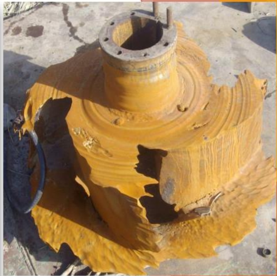
Общий вид грунтового насоса и износ
