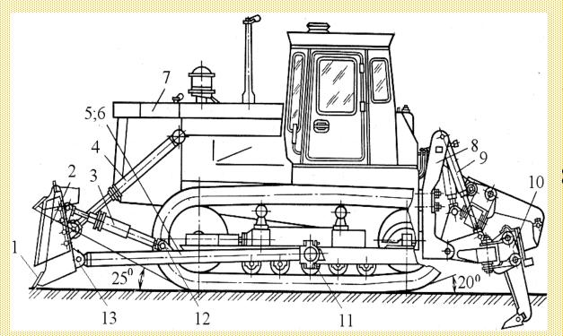
1-нож; 2-отвал; 3,4,9-гидроцилиндр; 5 и 6-балка; 7-трактор; 8-механизм навески; 10-рыхлитель; 11-шарнир; 12,13-проушины.
