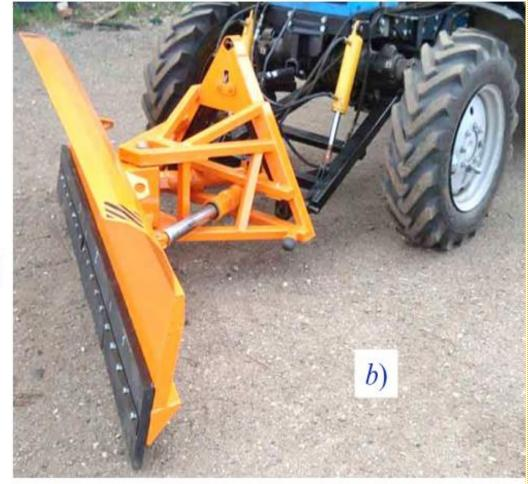
а- гусеничный с неповоротным отвалом; b- колесный с поворотным отвалом.
