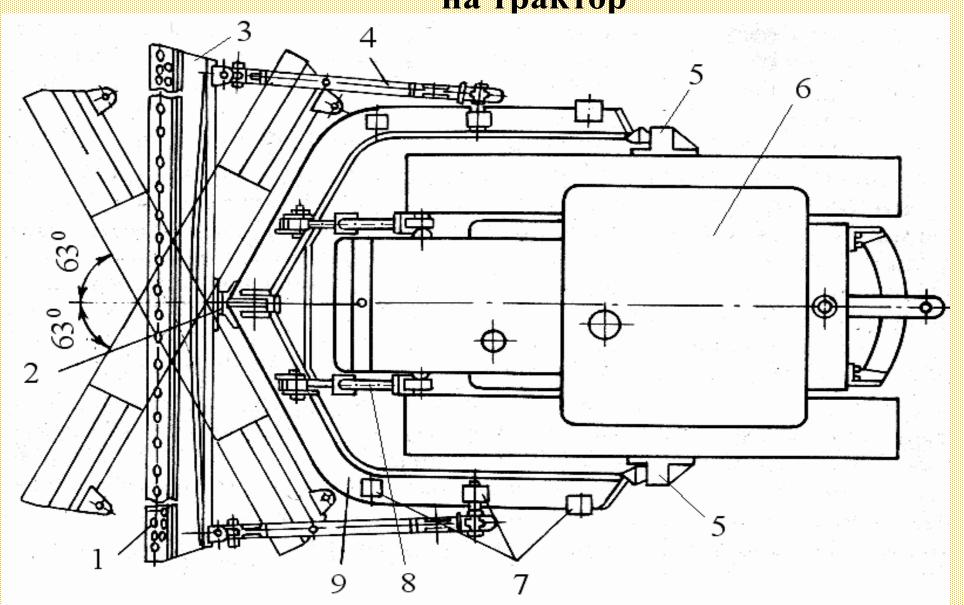
Бульдозер состоит из следующих основных частей: *трактора, навесного механизма, отвала, рамы, гидроцилиндров для подъема и опускания отвала.*
