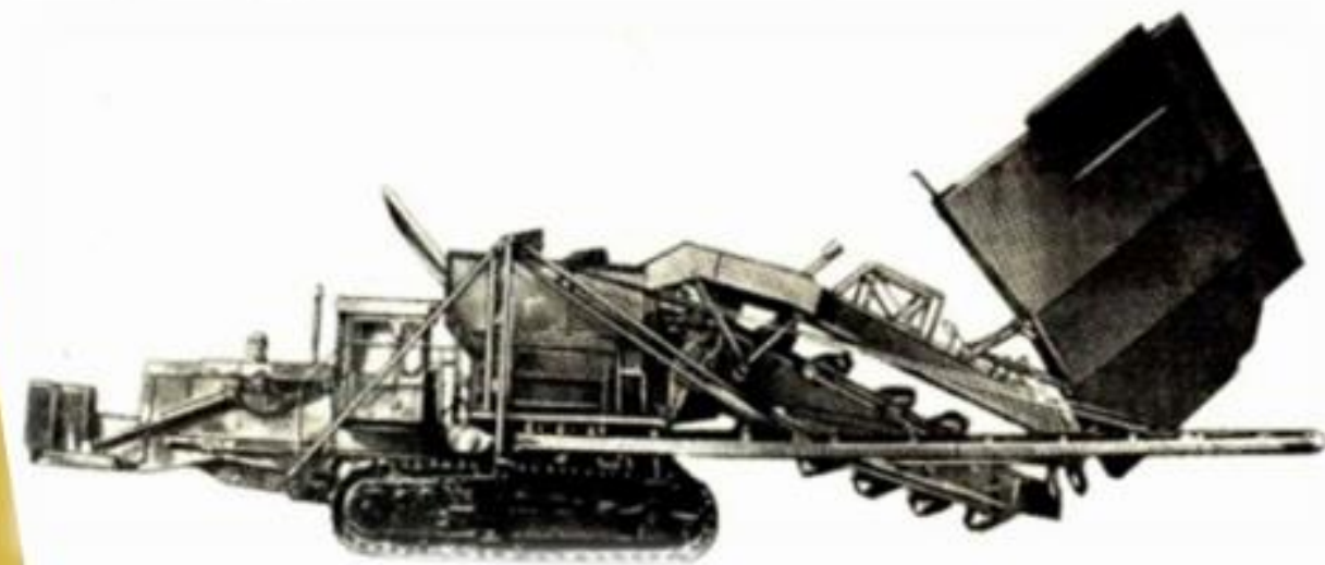
Экскаватор-дренажукладчик ЭТЦ-406: 1 — противовес; гидродомкраты; 2 — противовес; 4, 7 — поворота и подъема рабочего органа; 13 — корпус; 14 — трубоукладчик; 3 — тягач; 8 — трубоукладчик; 5, 11 — поперечный и осевой конвейеры; 6, 10 — подвижная рама и тяги трубоукладчика; 9 — подвеска осевого конвейера; 12 — трубоукладчик; 15 — рабочий орган; 16 — рычаг подвеса рабочего органа
