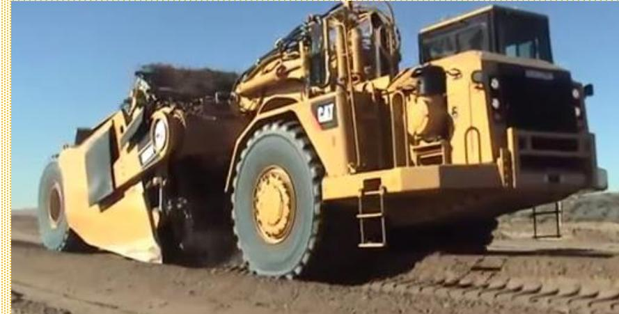
**По сравнению с двухосными прицепными скреперами**, работающими в сцепе с гусеничными тракторами, полуприцепные скреперы имеют в 2 - 2,5 раза большую производительность и примерно в 1,5 - 2 раза меньшую металлоемкость и энергоемкость.
