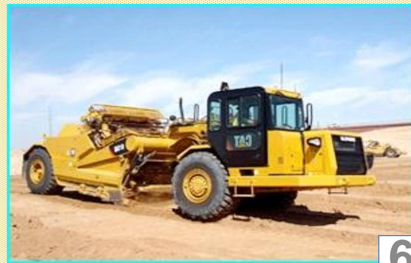
**Прицепной скрепер** – техника специализированного назначения, способная выполнять землеройные работы и доставлять изъятый с площадки грунт в место отсыпки. Также эти машины выравнивают и уплотняют почву в зоне проведения мероприятий.
