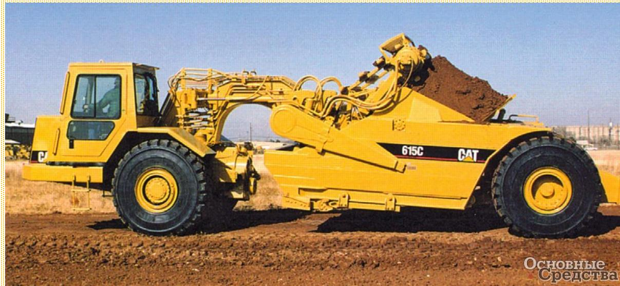
***Прицепной скрепер*** – техника специализированного назначения, способная выполнять землеройные работы и доставлять изъятый с площадки грунт в место отсыпки. Также эти машины выравнивают и уплотняют почву в зоне проведения мероприятий.
