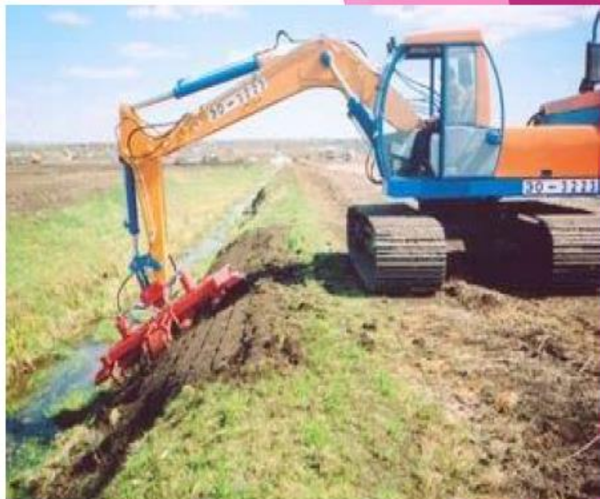
Планировщик-рыхлитель на ЭО-3223: а – работа фрез; б – планировщик-рыхлитель в работе
