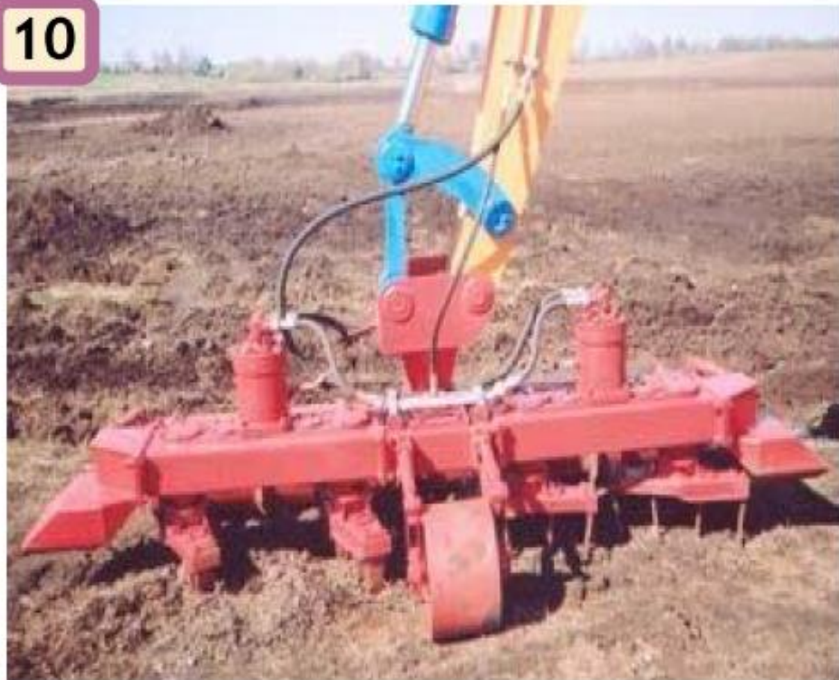
Планировщик-рыхлитель на ЭО-3223: а – работа фрез; б – планировщик-рыхлитель в работе
