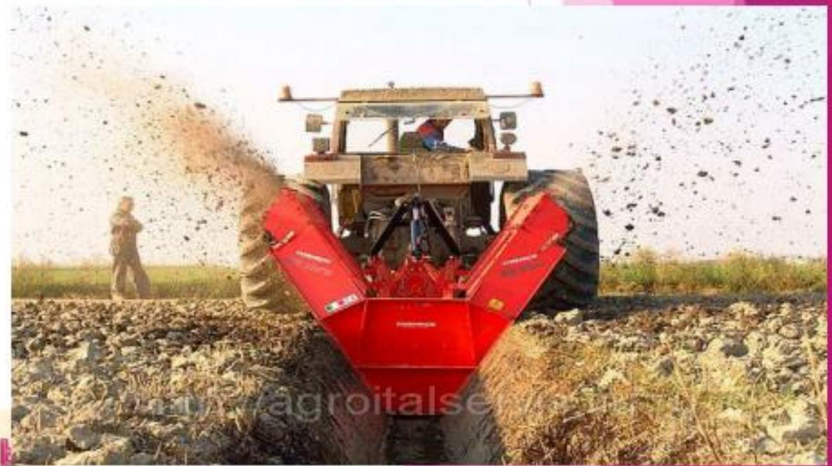
Навесной фрезерный каналокопатель
