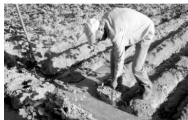
4- а) ва б) расмлар. Тажриба участкасидаги сув сарфи “Томсон” (90) ва “Чипполетти” (0,50 м) сув ўлчаш қурилмаси орқали аниқлаш.
