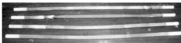
Рис.3. Карбидокремниевые нагревательные элементы, пришедшие в непригодное состояние.
