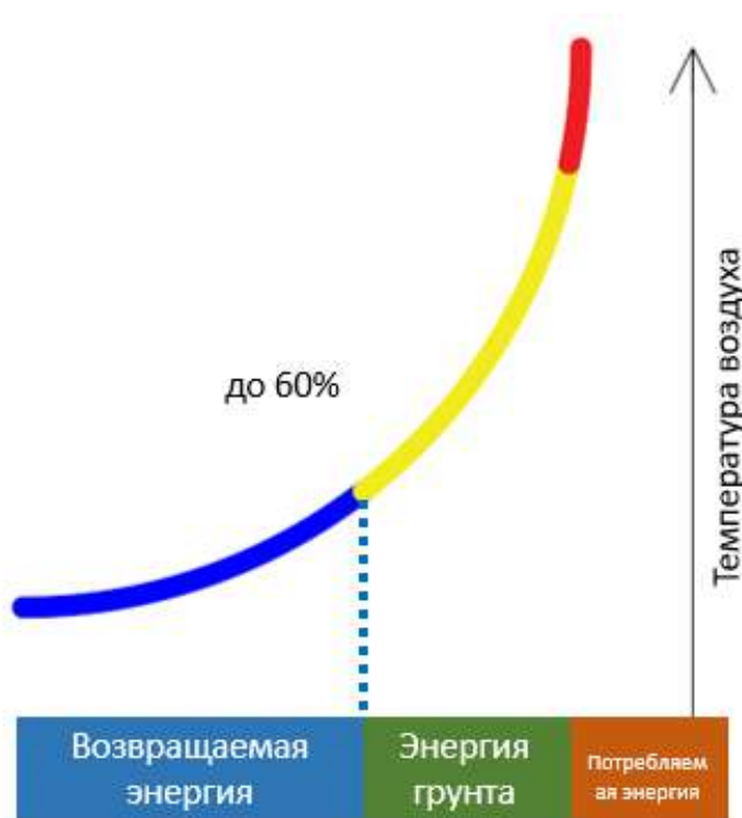
Рис.2. Доля участия различных потребителей в нагреве воздуха от минимальной температуры до температуры, подаваемой в помещение.
