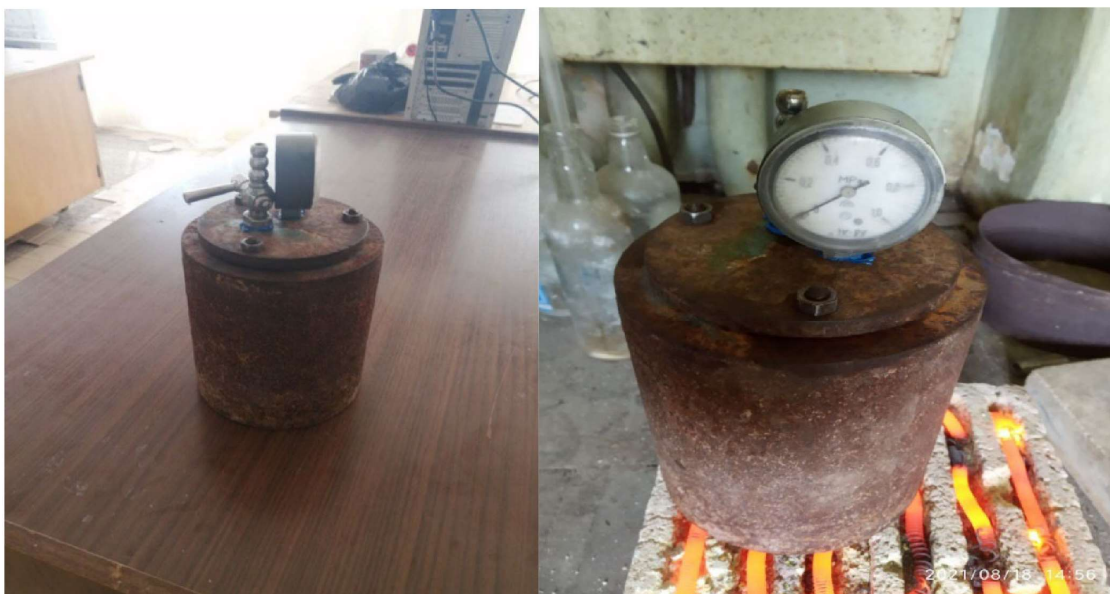
Рис.1. Автоклавы для получения жидкого стекла
