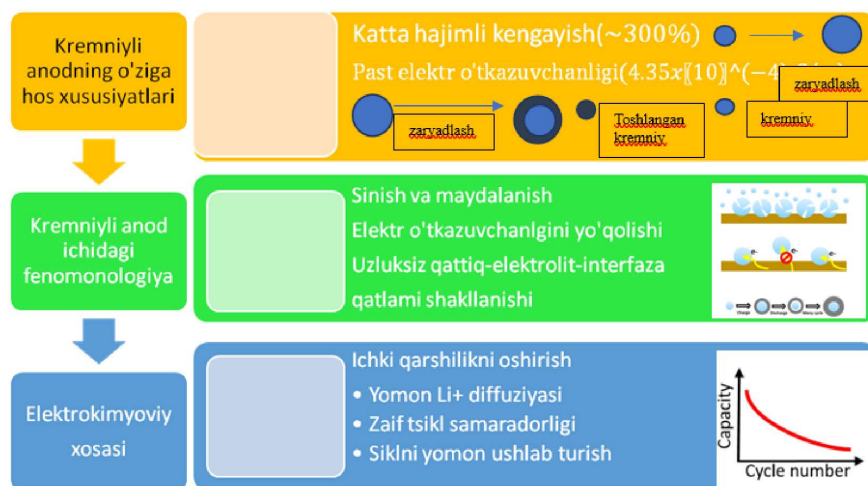
1-rasm. Kremniyli anodning nuqsonlari
