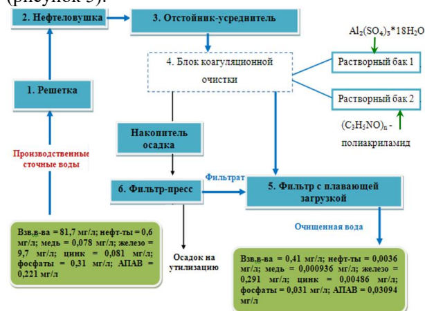
Рисунок 5. Схема очистки производственных сточных вод
