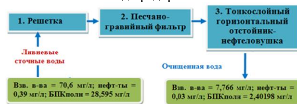
Рисунок 6. Схема очистки ливневых сточных вод
