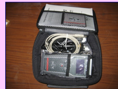
Ultrazvuk yordamida suv quvirlari qalinligini o‘lchash asbobi.
