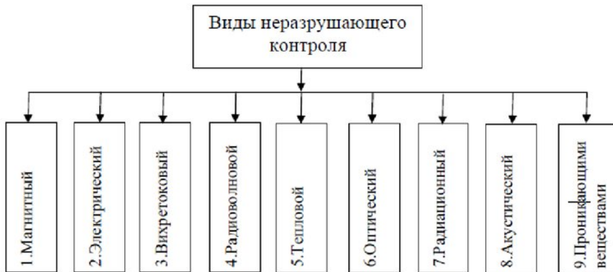
Рис. 1.8. Классификация видов неразрушающего контроля
