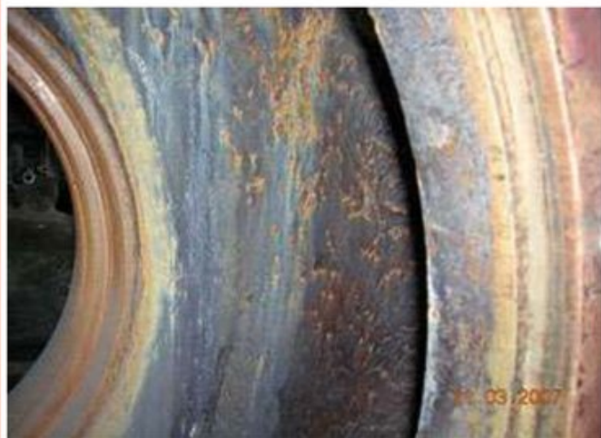
Рис. 1. Кавитация улитки после года работы насоса.
