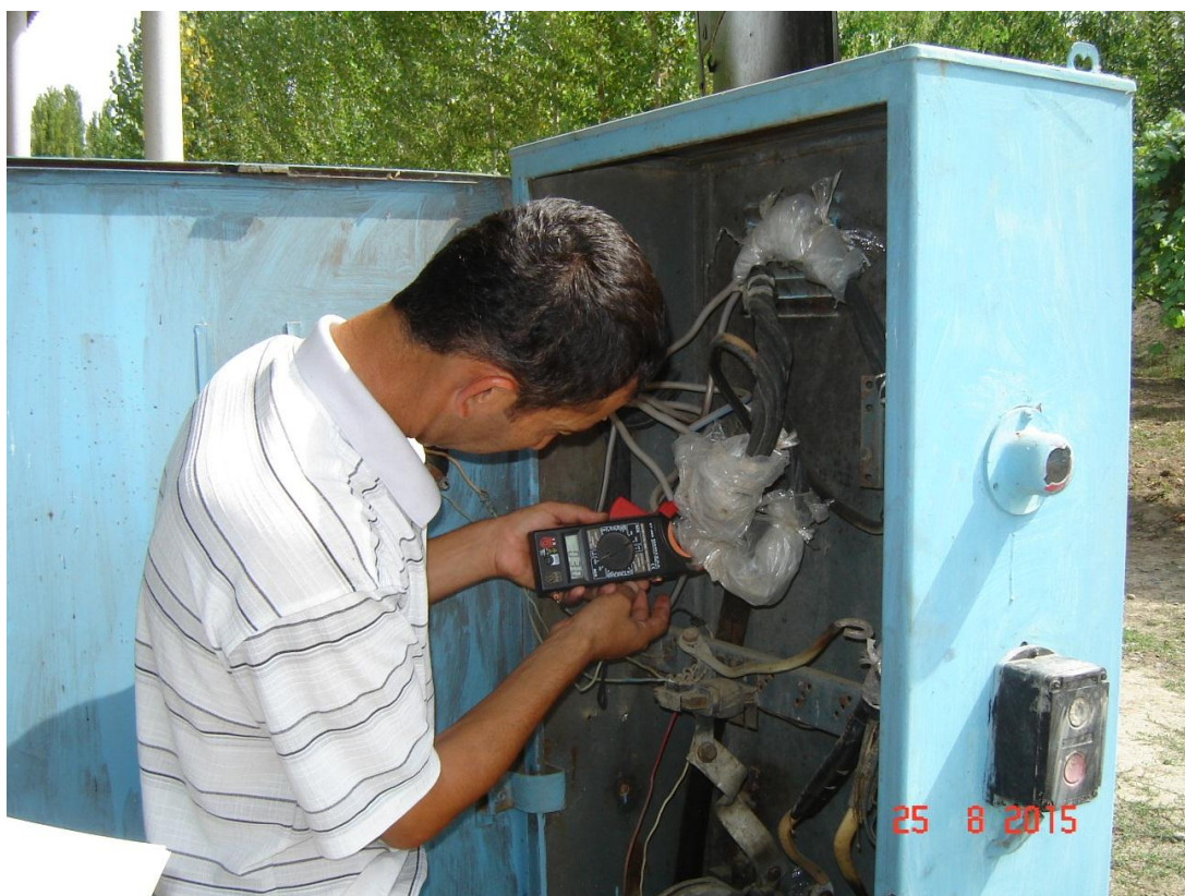
Рис.3.24. Измерение параметров тока при различных режимах работы насосного агрегата
