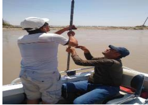
4-расм. Гидрометрик штанга таёрлаш ва чуқурлик ўлчаш ишлари.
