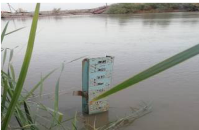
2-расм. Сув сатҳини ўлчаш рейкаси.
