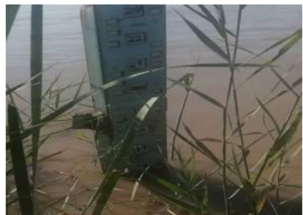
2-расм. Сув сатҳини ўлчаш рейкаси.
