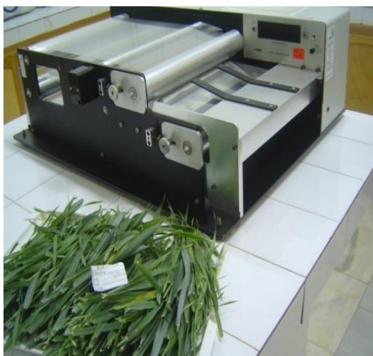
24-расм. Ўсимлик барг сатҳини LI-COR 3100 ускунаси ёрдамида аниқлаш
