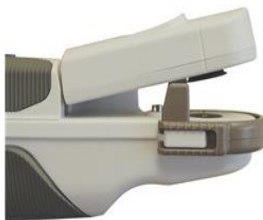
36-расм. Minolta SPAD-502 хлорофиллметр умумий кўриниши (чапда) ва барг киритилиб ўлчов бажарадиган қисми (унгда)
