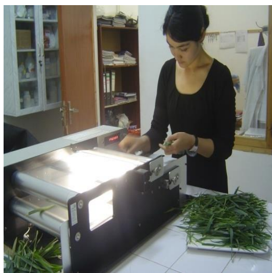
24-расм. Ўсимлик барг сатҳини LI-COR 3100 ускунаси ёрдамида аниқлаш
