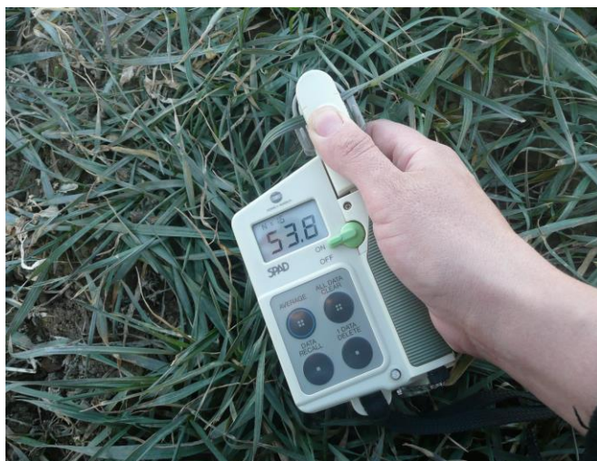
36-расм. Minolta SPAD-502 хлорофиллметр умумий кўриниши (чапда) ва барг киритилиб ўлчов бажарадиган қисми (унгда)
