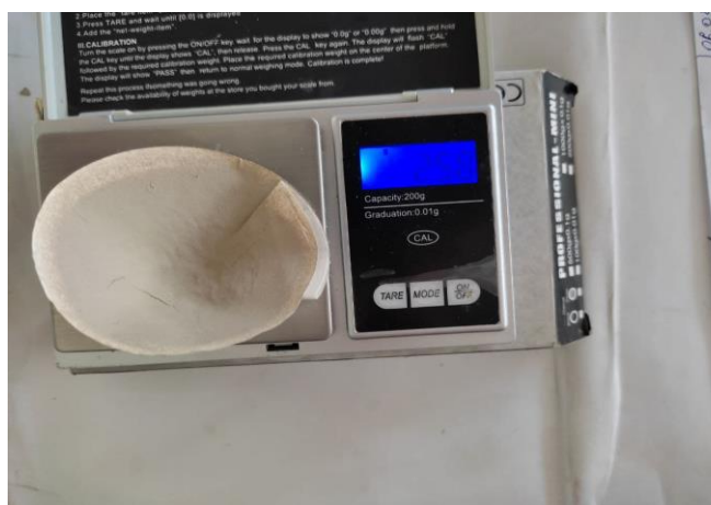
2.21-расм. Оқим таркибидаги лойқалик миқдорини лаборатория шароитида филтрдан ўтказиш жараёни
