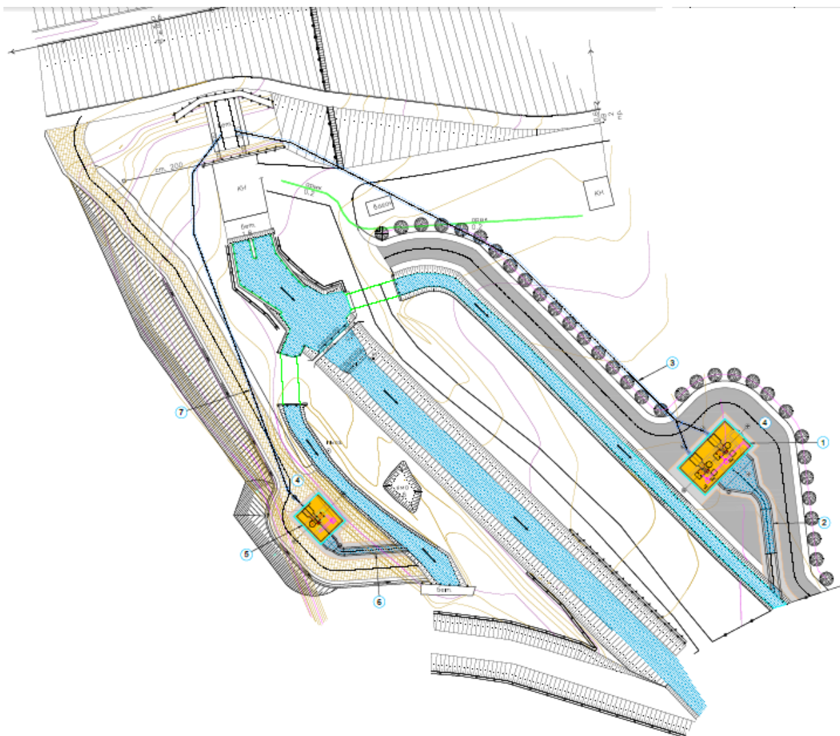
3.12-расм. Чортоқ сув омборига қурилган 825 кВт ли МикроГЭС нинг бош режаси
