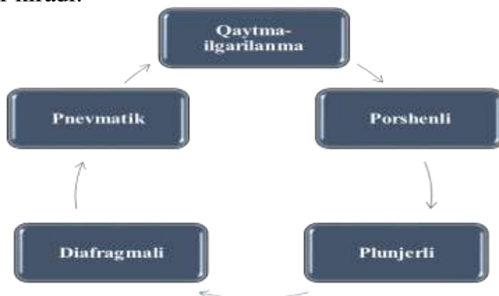
14.4-rasm. Hajmiy nasoslarning turlari
