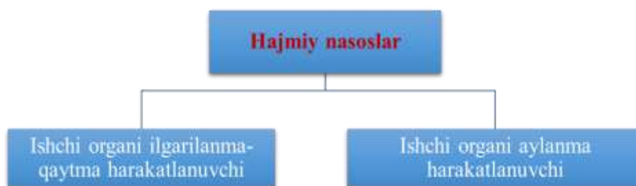
14.2-rasm. Hajmiy nasoslarning guruhlanishiga doir sxema
