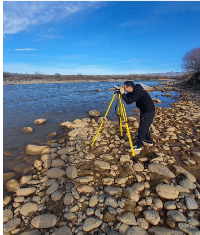
1-расм. GPS ва АТ - 32 оптик нивелир қурилмаларида геодезик тадқиқотлар.
