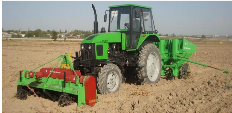
Рис.3. Комбинированный агрегат с фронтальной почвенной фрезой и картофелесажалкой
