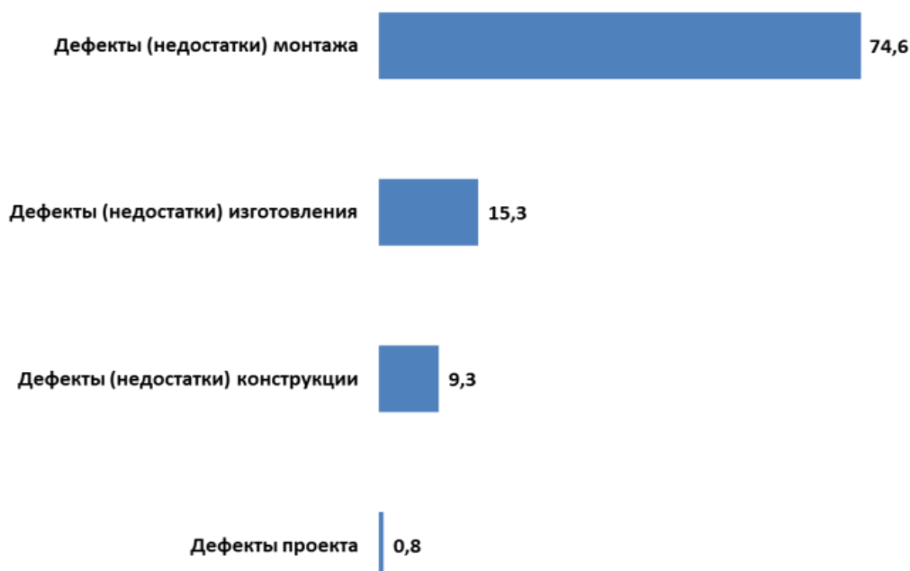
Рис. 4. Причины технологических нарушений вследствие недостатков в проектировании и дефектов конструкций, изготовления и монтажа, %
