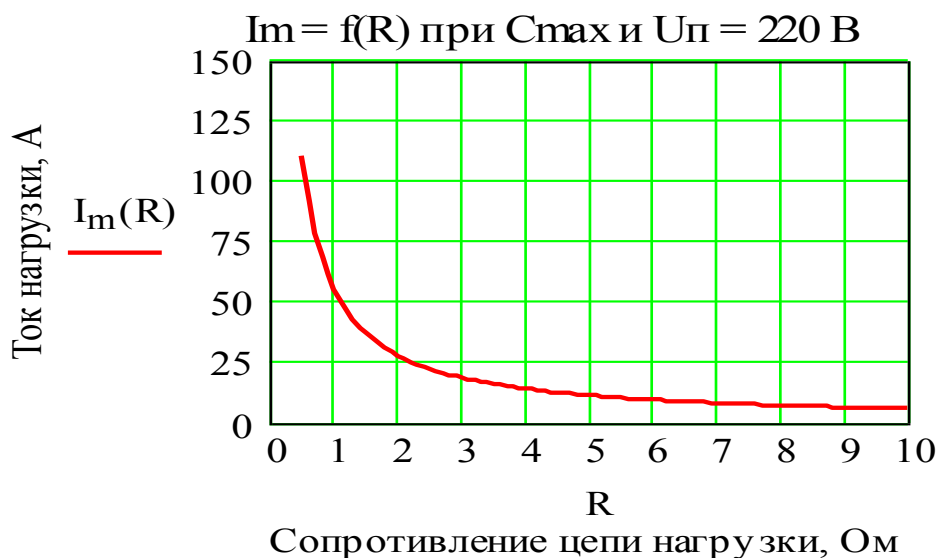
Рис. 5. Зависимость максимального значения тока ВКП с ДПЭ от сопротивления цепи нагрузки из условия полного заряда накопительного конденсатора при напряжении питающей сети 220 В и частоте 50 Гц
