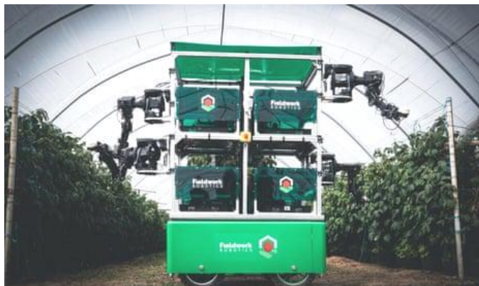
Рис. 4. Робот, разработанный Fieldwork Robotics, может собирать килограмм малины в час. Фотография: Fieldwork Robotics
