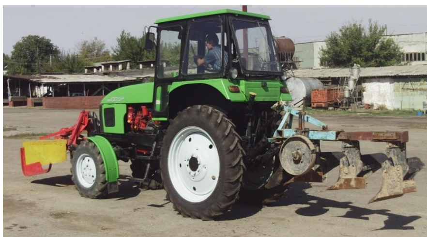
Рис.2. Комбинированный агрегат фронтальным ботво-стеблеизмельчителем и одновременная вспашка почвы задненавесным оборотным плугом
