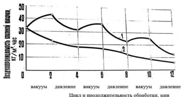
Рис.4. Изменение воздухопроницаемости коконной оболочки от способа влияния воздуха и продолжительности действия: 1-циклическая обработка коконов (вакуум-давление-вакуум-давление) на экспериментальной установке; 2-существующий способ обработки оболочки коконов на конвейерной сушилке СК-150К.
