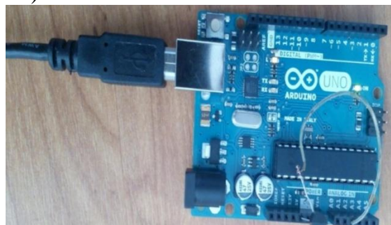
3.3-rasm. “Arduino Uno” va MCP 9700 datchigini ulash fotosuratlari.
