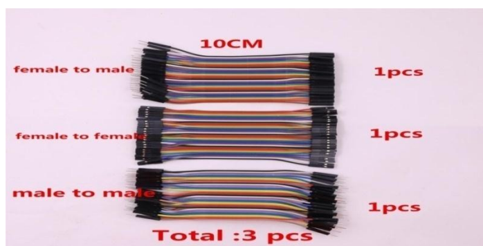
10.9-rasm. Qurulmalarni o‘zaro bog‘lovchi kabellar
