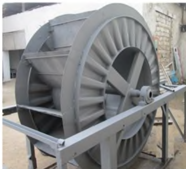
2-расм. Ишлаб чиқилган микро ГЭС сув чархпалаги
