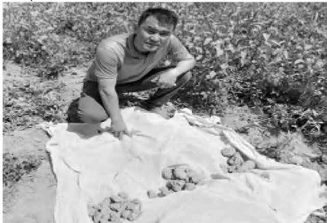
2-rasm. Elangan tuproq kesaklarini fraksiyalarga ajratish va o'lchash jarayoni.
