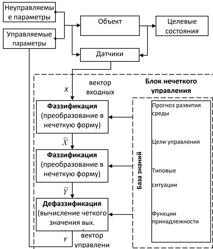
Рисунок 1—Обобщенная схема интеллектуальной системы управления с блоком нечеткого управления
