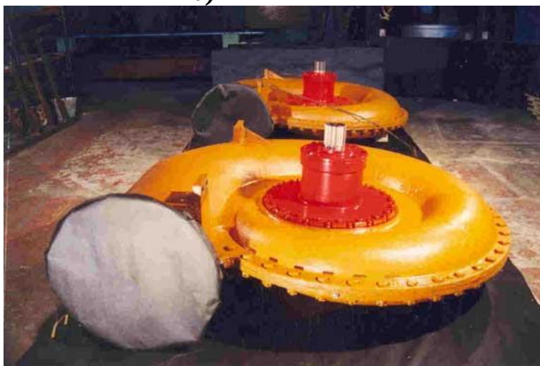
104-rasm. Vertikal(a) va gorizontal (b) oʻrnatiladigan radial-oʻqiy turbinalar.
