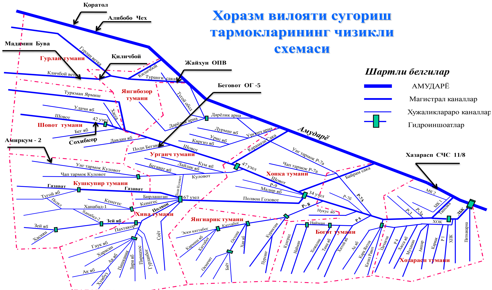
17-rasm. Xorazm viloyati sug'orish tarmoqlarining chiziqli sxemasi.
