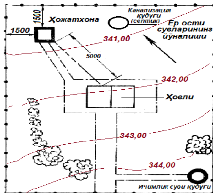
44-расм. Ҳовлидаги ҳожатхона ва канализация қудуғининг жойлашиш схемаси.
